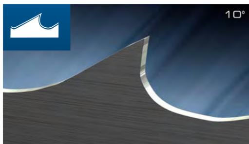
El diente Hook tiene un ángulo de corte de 10°. Este diente es particularmente adecuado para cortar macizos, tubos de gran espesor y materiales de alta aleación
