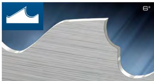
El diente profile resiste las vibraciones durante el corte de vigas y tubos gracias a su geometría reforzada. Este efecto se intensifica gracias al ángulo de corte reducido a 6°.
