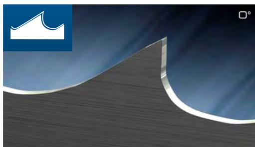
El diente normal tiene un ángulo de corte de 0°. Es apropiado para costar materiales con un alto contenido de carbono (como hierro fundido), materiales con secciones transversales pequeñas y perfiles y tubos de espesor fino.
