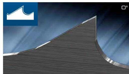
El diente normal tiene un ángulo de corte de 0°. Es apropiado para cortar materiales con un alto contenido de carbono (como hierro fundido), materiales con secciones transversales pequeñas y perfiles y tubos de espesor fino.
